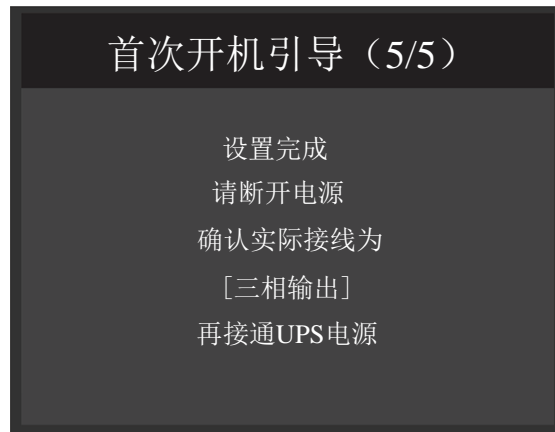
图6 设置完成 (16kVA/20kVA)
