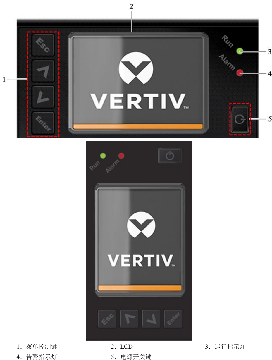
图4-1 操作显示面板
