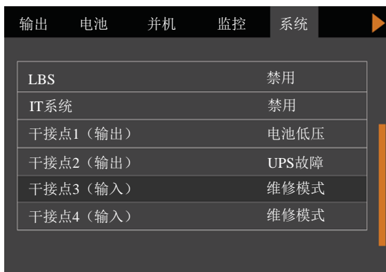
图5-7 确认干接点 3 为“维修模式”
