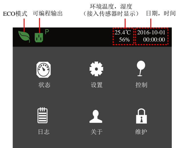
图4-2 LCD 显示屏示意图
